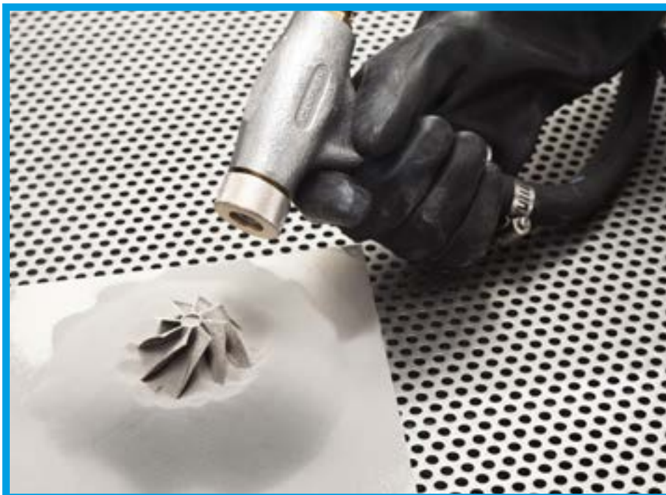
Ilustración 14 - Con muchas máquinas híbridas, el post procesado es obligatorio (Fuente: http://addaero-mfg.com/wp-content/uploads/2018/01/addaero-spray-booth.jpg )
