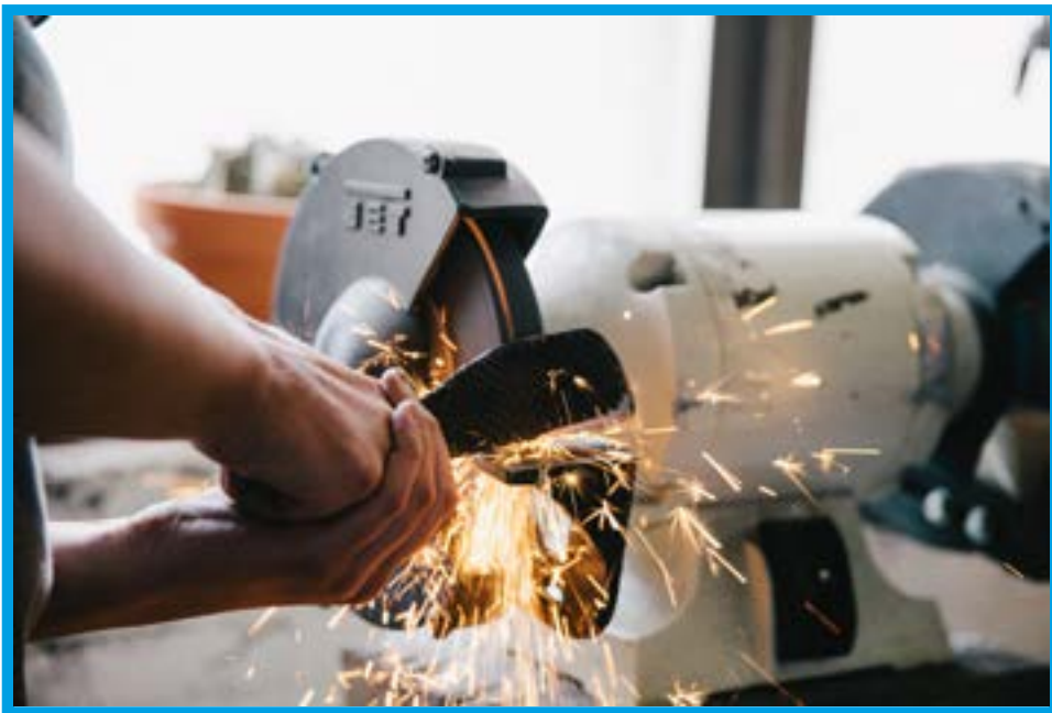
Ilustración 1 - Ejemplo de fabricación sustractiva (Fuente: Chris Ralston para Unsplash)
