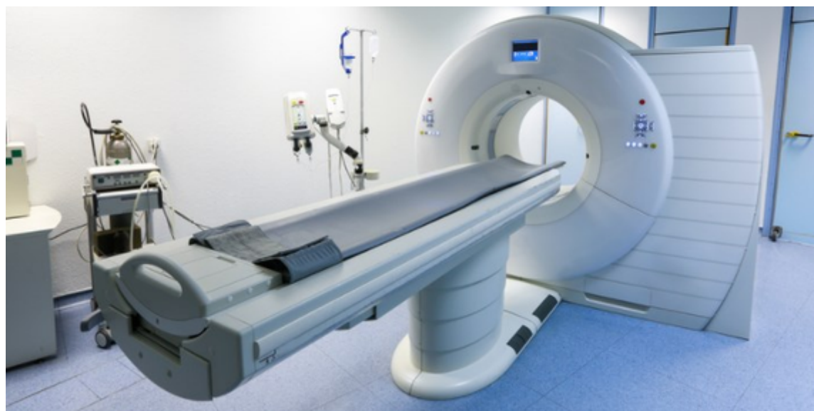
Figura 1: Aparato de tomografía similar al de uso médico para análisis de porosidad.
